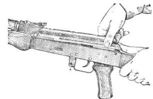
6. **Спустить курок с боевого взвода и поставить на предохранитель.** Нажать на спусковой крючок и поднять переводчик вверх до отказа.
